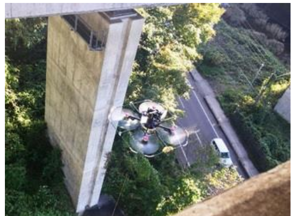
写真 インフラ点検ロボット「マルコ」
